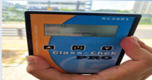
계단실 창호 / 유리두께 측정
